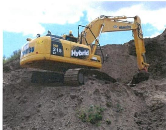
Mobile Arbeitsmaschinen wie Bagger, Radlader oder Muldenkipper sind nach wie vor – energetisch betrachtet – wenig effizient. Zu viel Energie verpufft bei allen Komponenten nutzlos. Aus diesem Grund wird sich die Hybridtechnik im Gegensatz zum Automobilbau kurzfristig durchsetzen, denn Kraftstoffersparnisse bis zu 40 % lassen grüßen.
